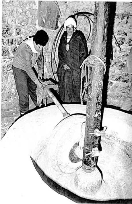
FIG. 55. — Le moulin. M. Chérif Menaceur tient le bât de l'âne qui, pendant la campagne de trituration, entraîne le mouvement de la meule (cl. J. Mermet).
