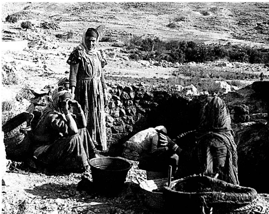
FIG. 61. — Vallée de l'oued Bedjer. Au premier plan, deux couffins d'alfa, dans lesquels a été transportée la pâte d'olives écrasées ; penchée dans une cuve grossièrement maçonnée, une femme triture cette pâte avec les pieds pour en faire sortir l'huile ; le liquide est versé dans la bassine métallique, posée sur un petit foyer afin de séparer par ébullition l'eau de l'huile. L'opération est suivie par une femme plus âgée et les deux autres attendent de relayer la première.
